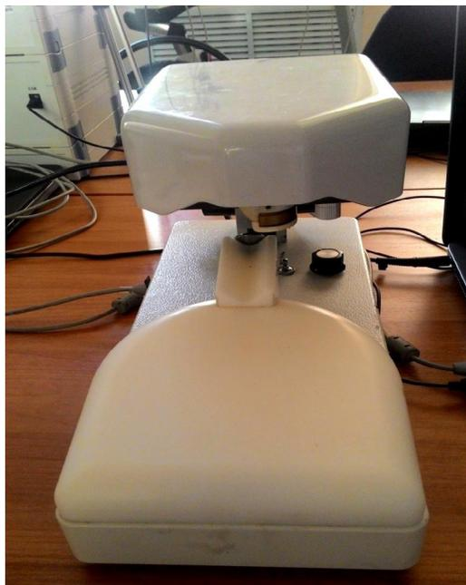
Рис. 1. Компьютерный капилляроскоп
